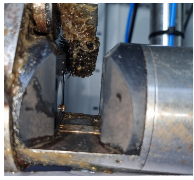
■ 브러쉬 세정장치 위치가 잘못 정렬된 사진
